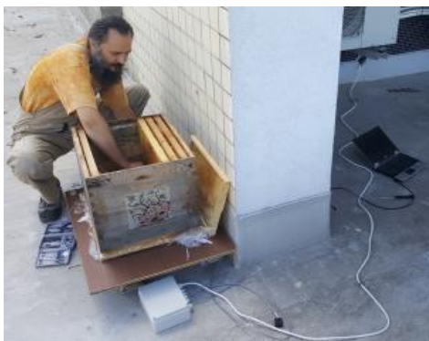
Obrázok 2: Kalibrácia váhového senzora
