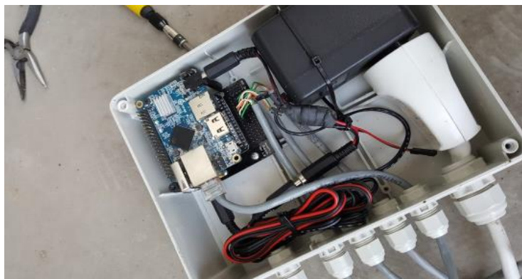
Obrázok 3: Zapojenie senzorov a kamier do riadiacich dosiek
