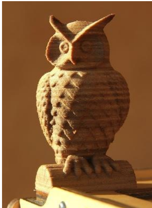
Obrázok 5: Model vytlačený z WPC materiálu
