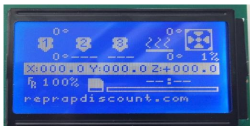
Obrázok 4: LCD display pre RepRap tlačiarne
