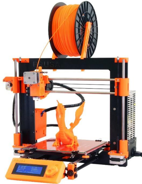
Obrázok 3: Jedna zo súčasných RepRap tlačiarňí, model Prusa i3
