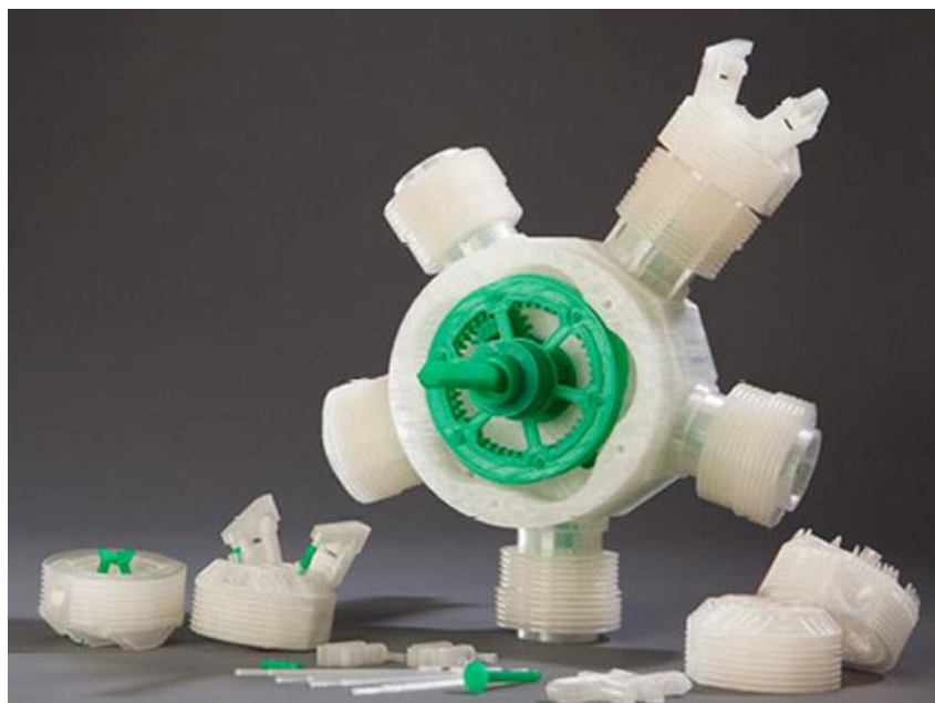
Obrázok 6: Model vytlačený z PLA materiálu
